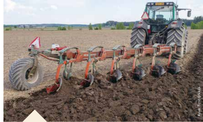
Timo Erkkilä Lapualta hankki käytetyn kuusiteräisen Kvernelandin puolihinattavan sarka-auran ja muutti sen sängeltä kyntöön sopivaksi laajentamalla auran sivuttaissiirtoa.
