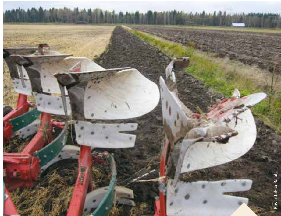
Kvernelandin lisävarusteena myytävällä terällä ja Grenen yleismallilla kuohkeutetaan vaon pohjaa noin 8–12 sentin syvyydeltä. Terä kiinnitetään kahdella pultilla maapuoleen. Viimeiseen terään jankkuriterää ei ole syytä kiinnittää, jos siinä kulkee vakopyörä seuraavalla ajokerralla. Kovimmilla mailla leveää jankkuriterää voi kaventaa. Laukaisulaitteeseen voi olla tarpeen lisätä yksi lisälehti.
