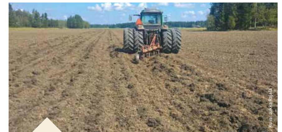
Maan kuohkeutusta siivettömällä kyntöauralla noin 25 sentin syvyyteen. Aurasta on siivet ruuvattu irti ja aura säädetty kulkemaan vasemman pyörän raiteessa. Paripyöriä voidaan käyttää molemmilla puolilla, kun pinta on ensin muokattu hienoksi.
