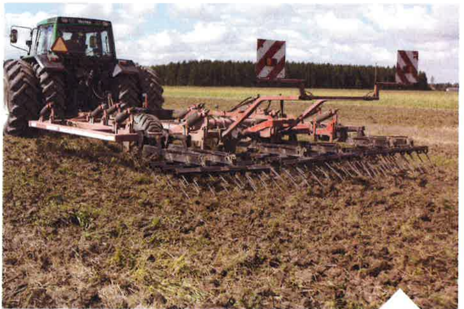
4,5 metrin levyinen kultivaattori hanhenjaloilla varustettuna on melko kevyt vetää, kun työsyvyyttä lisätään vähitellen.
