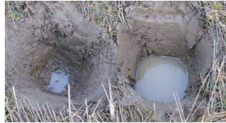
Maan läpäisevyydestä saadaan arvokasta tietoa seuraamalla veden pinnan nousua kuopissa kuoppien kaivun jälkeen. Kuvien kuoppiin vesi on noussut kaurapeltokuvan pellolla 20 minuutissa kuoppien kaivamisen jälkeen joulukuun alussa. Salaojan kohdalla (kuva vasemmalla) vettä kertyy kuopan pohjalle vain hieman. Salaojien väliin kaivettuun kuoppaan (kuva oikealla) kuopassa vesi on noussut ruokamultakerroksen alaosaan. Veden pinta on jatkanut nousua kuoppiin myös kuvien ottamisen jälkeen.
