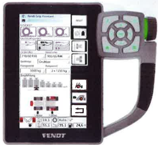
↑ Kuva 8. Fendt Grip Assistant opastaa painottamaan traktorin optimaalisesti eri työkoneyhdistelmillä ja muuttuvissa olosuhteissa. Järjestelmä antaa myös vastaavat suositukset rengaspaineille. Fendt-traktoreihin on myös saatavissa rengaspaineiden hallintajärjestelmä, jolla yksittäisten pyörien rengaspaineita voidaan säätää ajon/työn aikana.
