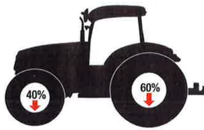
Taka- akselipaino 3 900 kg > pyöräkuorma 1 950 kg/pyörä. Etuakselipaino 2 600 kg > pyöräkuorma 1 300 kg/pyörä. (Lähde: MITAS)
