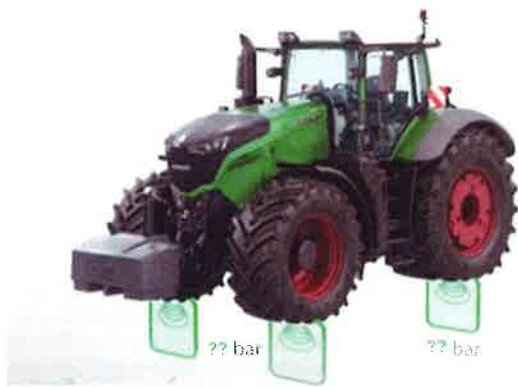
↑ Kuva 8. Fendt Grip Assistant opastaa painottamaan traktorin optimaalisesti eri työkoneyhdistelmillä ja muuttuvissa olosuhteissa. Järjestelmä antaa myös vastaavat suositukset rengaspaineille. Fendt-traktoreihin on myös saatavissa rengaspaineiden hallintajärjestelmä, jolla yksittäisten pyörien rengaspaineita voidaan säätää ajon/työn aikana.
