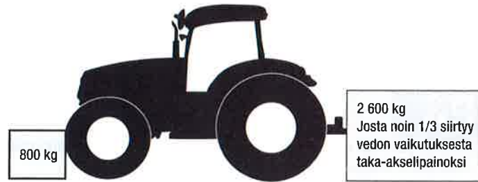
Taka- akselipainoksi muodostuu 5 000 kg (3 900 kg + (2 600 kg + 800 kg)/3). Pyöräkuormaksi tulee 2 500 kg/pyörä. Etuakselille jää 3 200 kg eli edessä pyöräkuormaksi tulee 1 600 kg/pyörä. Painojakauma vetotyössä etu- ja taka- akselin kesken on lähes alkuperäinen 60 %/40 %. (Lähde: MITAS)
