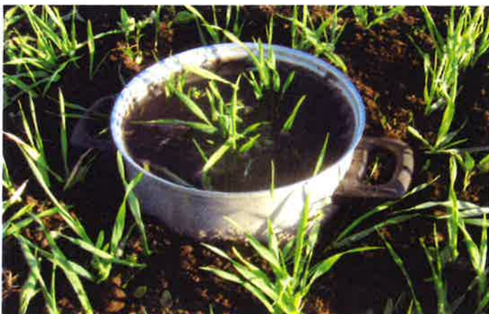
Maan vedenläpäisykykyä on kätevää mitata pohjattomalla kattilalla.
