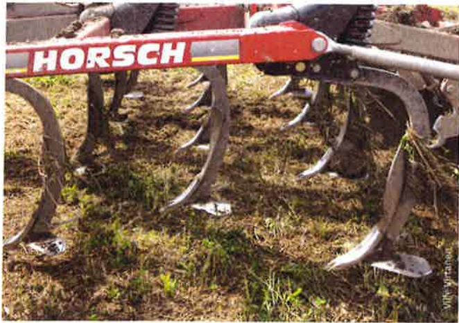
△ Horschin kultivaattorissa vakiona käytettävät siipiterät.
