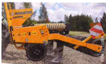
◁ Agrisemin jalat ja niiden edessä kiekkoileikkurit, automaattijousitus ja viimeistelyjyry.
