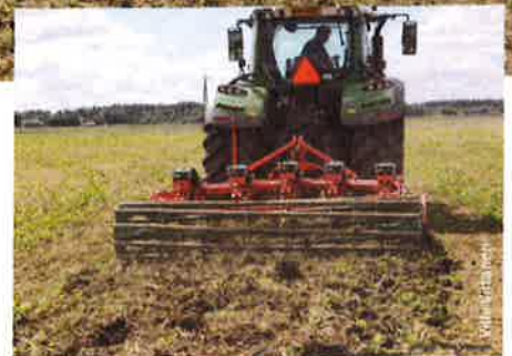
▷ Unian 3 m jankkuri muokkasi 5 jalalla syväkuohkeutuksen lisäksi maan pintakerroksen kultivaattorin tapaan. Kone on sänkijankkuri.
