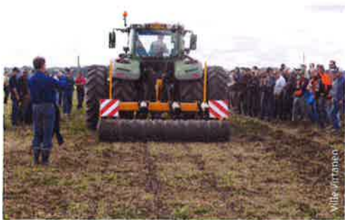
△ Jankkuri Agrisem viidellä jalalla jätti nurmen pinnan aivan tasaiseksi savimaallakin. Kone soveltuu hyvin nurmen jankkurointiin.
