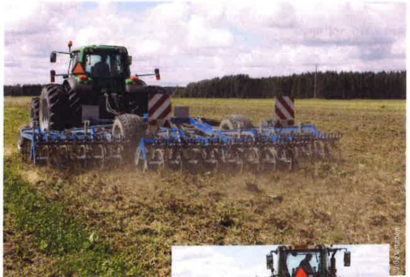
▷ Unian 3 m jankkuri muokkasi 5 jalalla syväkuohkeutuksen lisäksi maan pintakerroksen kultivaattorin tapaan. Kone on sänkijankkuri.
