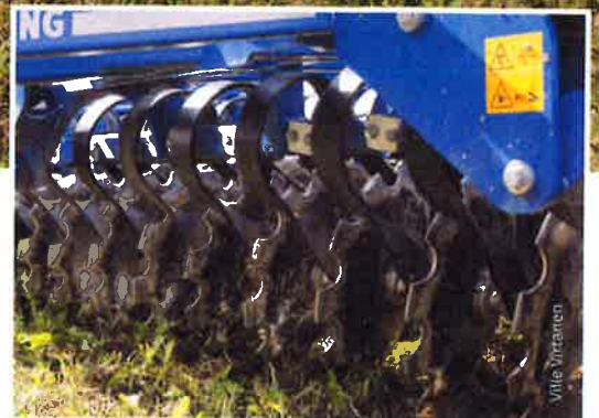
Köckerlingin lautaset ovat erillisjousitetut. Lautaskulma vaikuttaa suuresti muokkaustulokseen.
