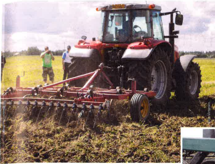
△ Vanha Potila kultivaattori päivitettiin siipiterin rikkoi nurmen lähes yhtä hyvin kuin uudemmatkin kultivaattorit.
