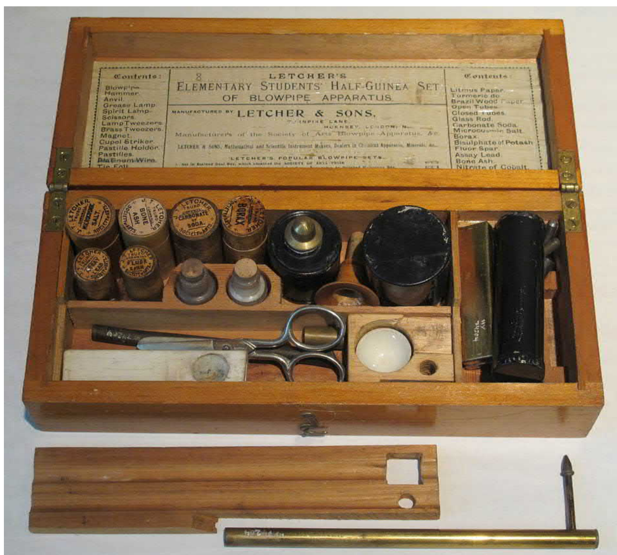
Geologien käyttämä puhallusputki (Blow-pipe) -laitteisto. Sillä tehtiin mineralogisia pika-analyysejä kenttäoloissa. Kuva Sanna-Mari Niemi 2014.
