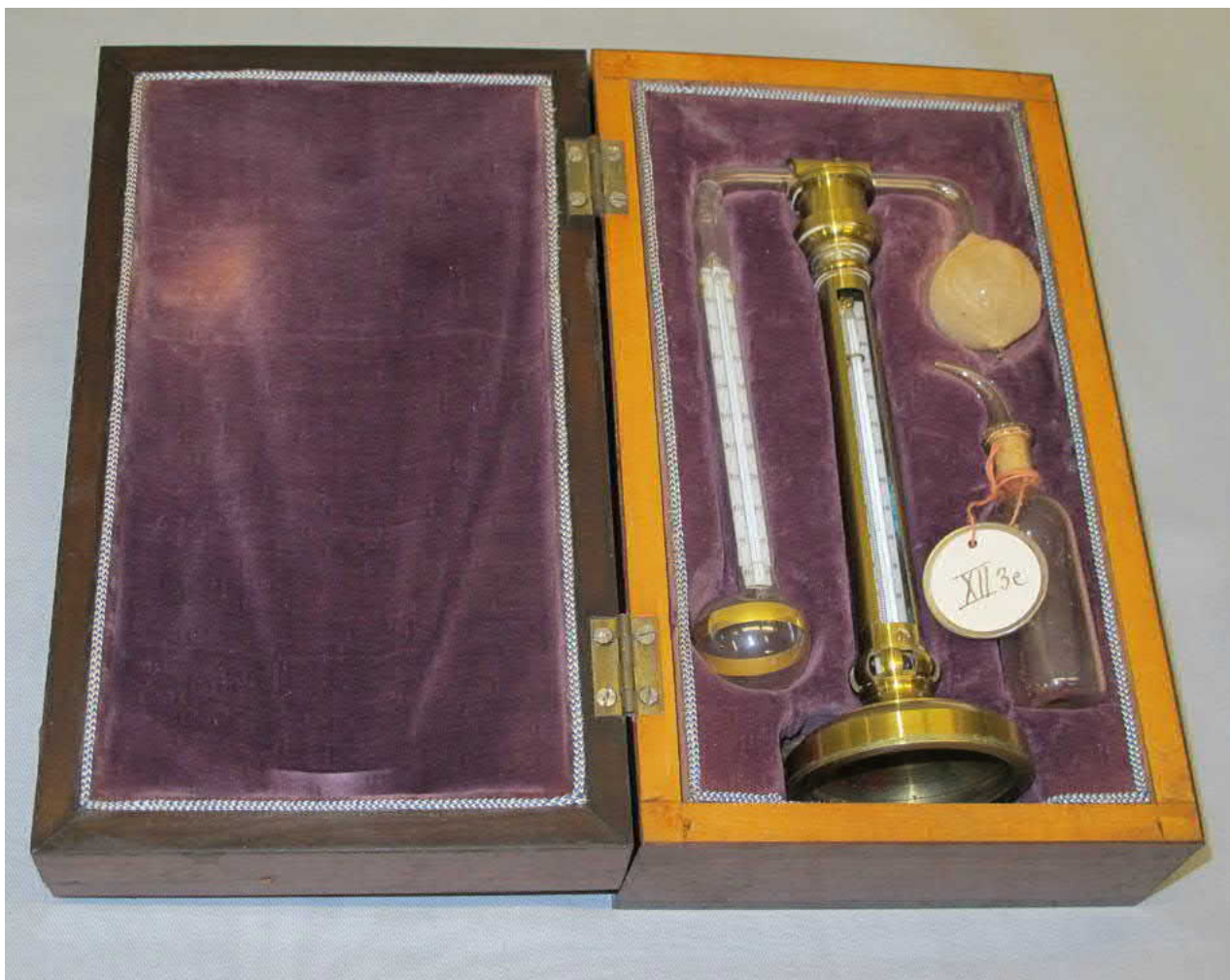
Fysiikan kabinetin kokoelmaan kuuluva Daniellin kondensaatiohygrometri vuodelta 1839. Kuva Susanna Åke 2014.
